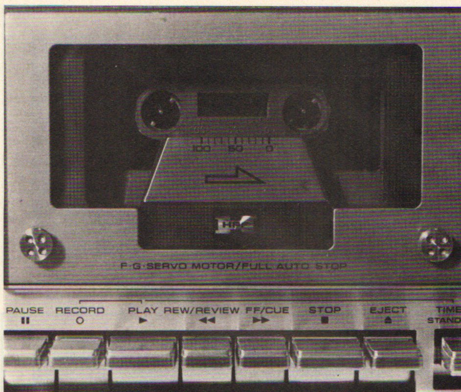
La porte protégeant la cassette peut facilement se démonter pour l'entretien des têtes.
